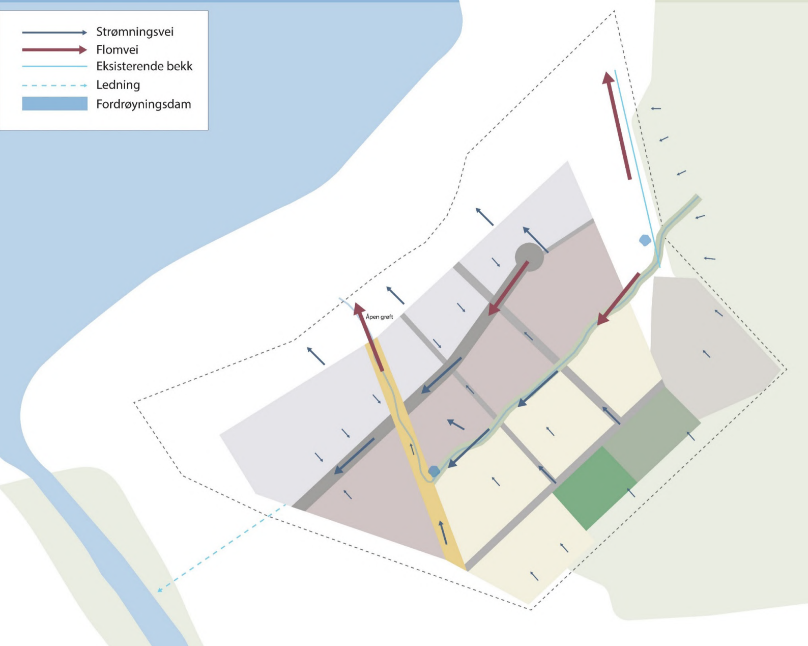
Figur 19: Prinsipp for overvannshåndtering. Kilde: Sweco
