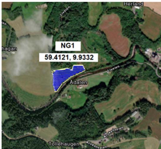
Figur 2-3: Grov skisse av plassering av panelrader for det vestre delområdet, NG1. Designet viser maksimal kapasitet på området. Hovedpunkt for tilknytning er foreløpig satt til nordvestre hjørne.
