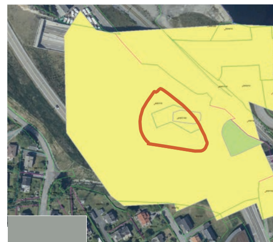
Grunnforhold - forurenset grunn - tidligere bensinstasjon
