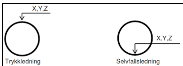
Figur 1. Innmåling av ledningshøyde
