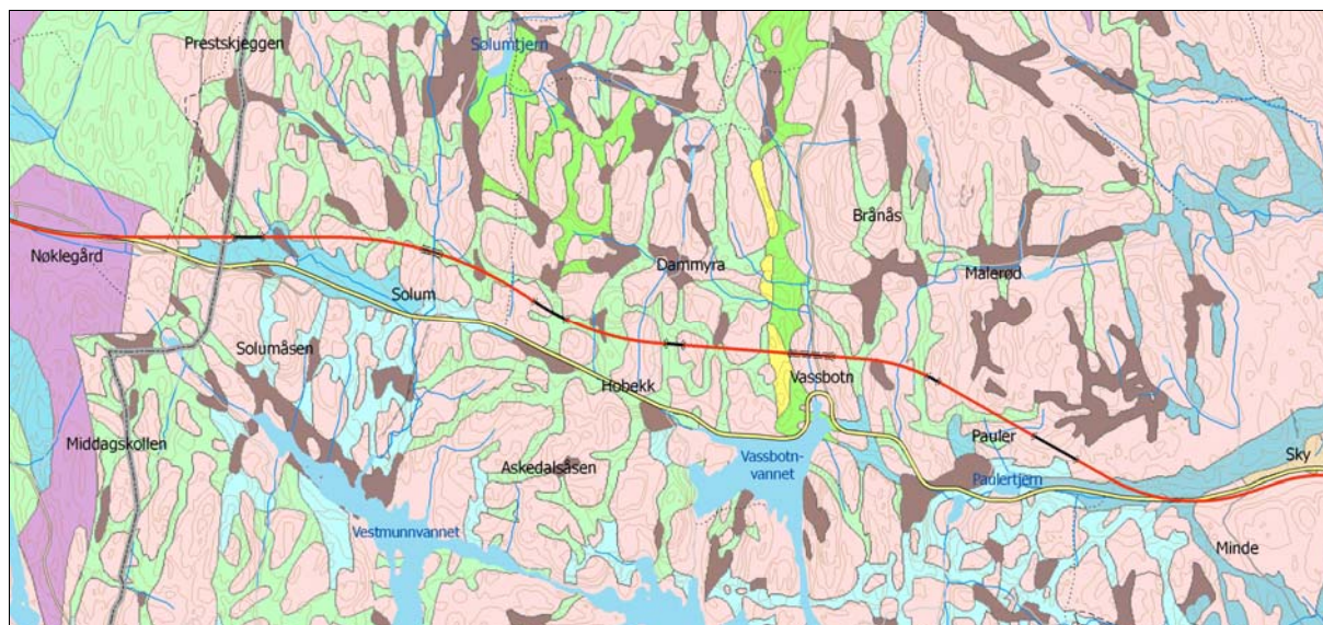
Figur 4: Løsmassekart for influensområdet. Rosa farge er bart fjell, mørk blå farge er strandavsetninger, lys grønn farge er usammenhengende tynt morenedekke, lys grønn farge er morenedekke med noe større mektighet og gul farge viser elve-/bekkeavsetninger.
