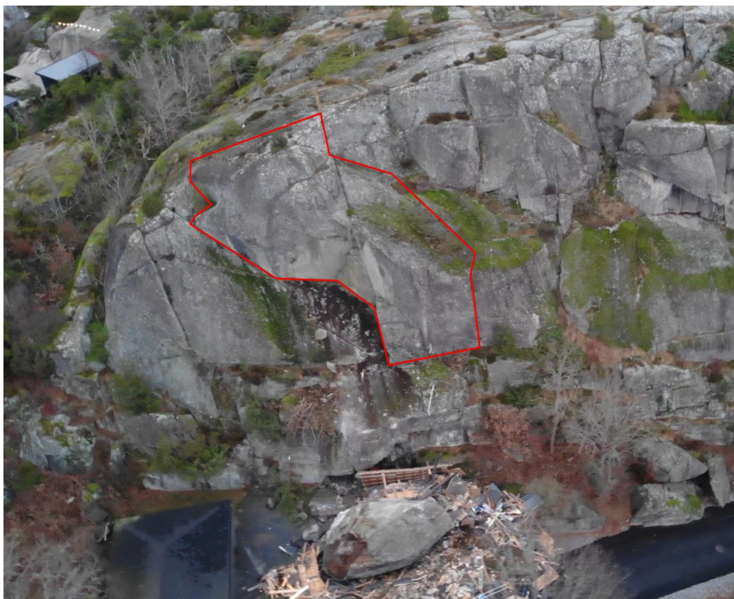
Bilde 2: Antatt ustabile blokker marker i rødt. Dronebilde: Kenneth Hansen
