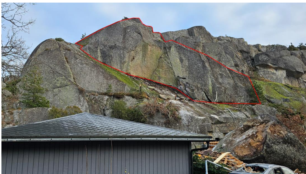
Bilde 3: Antatt ustabile blokker markert i rødt. Bildet er tatt fra bakkeplan, vest for raset.
