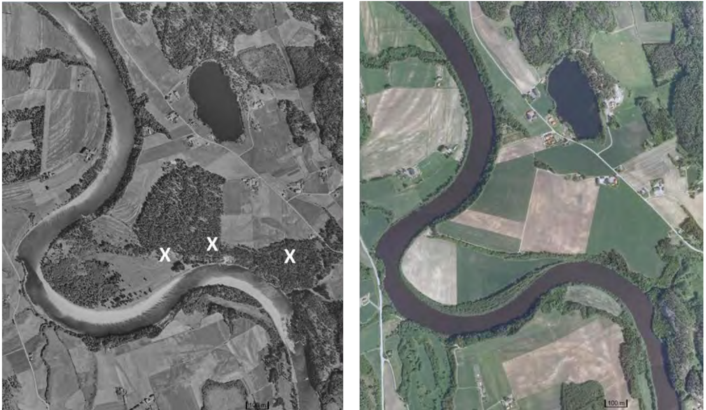
Figur 4-27: Flybilder fra Husvann området fra 1959 (venstre) og 2007 (høyre). Ved å sammenlikne bildene med Tegning S4 i Vedlegg F kan man se at store skogsområder er blitt hogd ned i områder utsatt for ravinering. Disse er merket med "X" i bildet til venstre.
