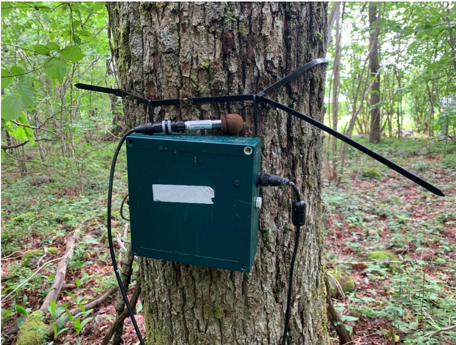
Figur 6-4. Ultralydlogger 2 med avmontert mikrofon. Foto: L. Berge
