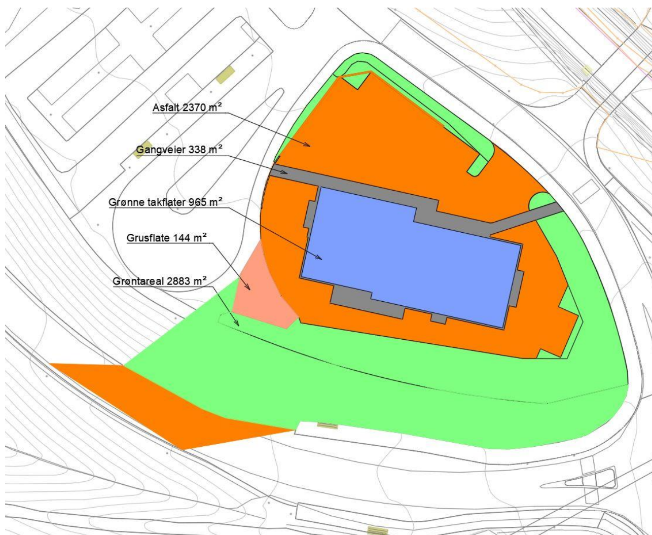
Figur 5 Nedslagsfelt og avrenningsflater etter ombygging
