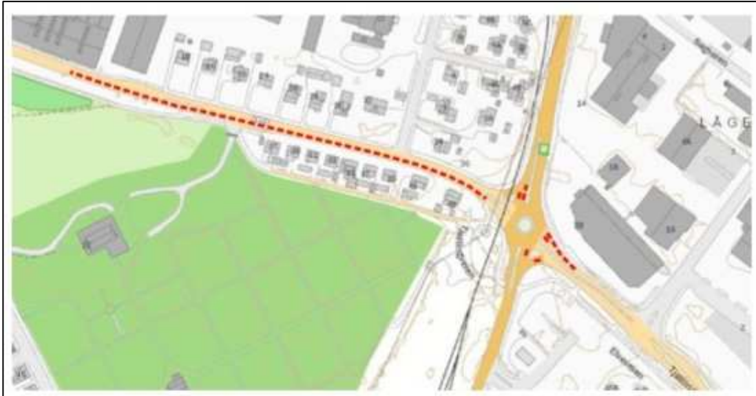
Figur 7-6: Beregnet kølengde etter fem minutters stenging, virkedag kl. 13 – 14. Kilde: Asplan Viak (2017) Togtrafikk gjennom Øyakrysset – trafikkanalyse.
