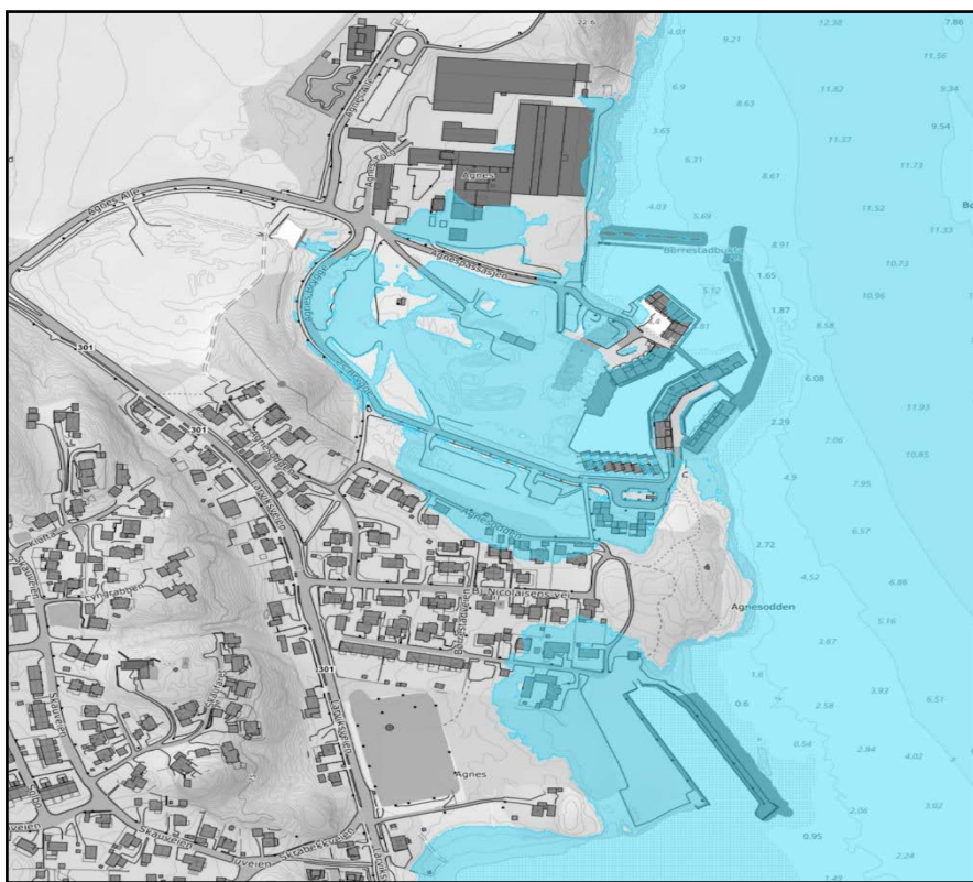
Figur 13 - Kartutsnittet viser Agnes og Sjøparken. Flere bygninger og veier kan bli rammet. I Sjøparken er det også garasjeanlegg under leilighetsbyggene.
