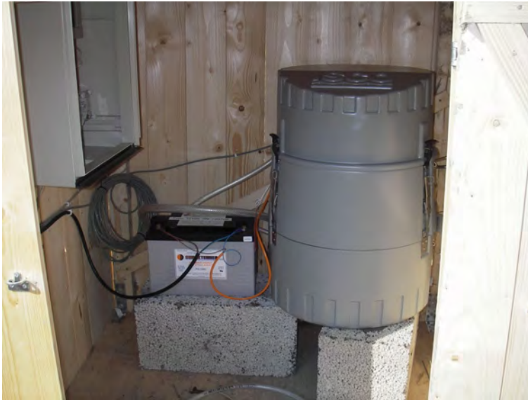
Fig. 3.12. Målestasjon for suspensjonstransport i Istreelva.
