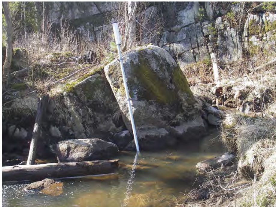
Fig. 3.8. Målestasjon for vannføring i Eikedalsbekken ved Malerød.
