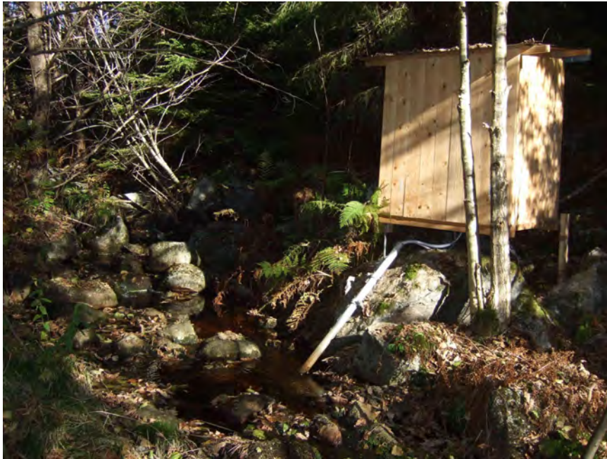
Fig. 3.9. Målestasjon for suspensjonstransport ved Moland.
