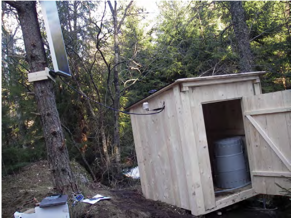
Fig. 3.7. Målestasjon for suspensjonstransport i Eikedalsbekken ved Malerød.
