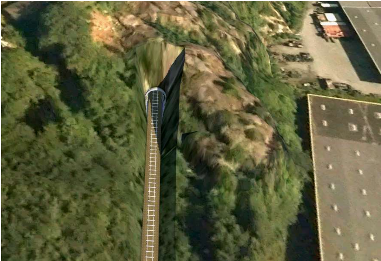
Figur 3-4 Portal i enden av tunnel for havnesportilknytningen. Antatt plassering av påhugg er vist, mens portalkonstruksjonen og terrengtilpasning i området ikke er fullstendig modellert.
