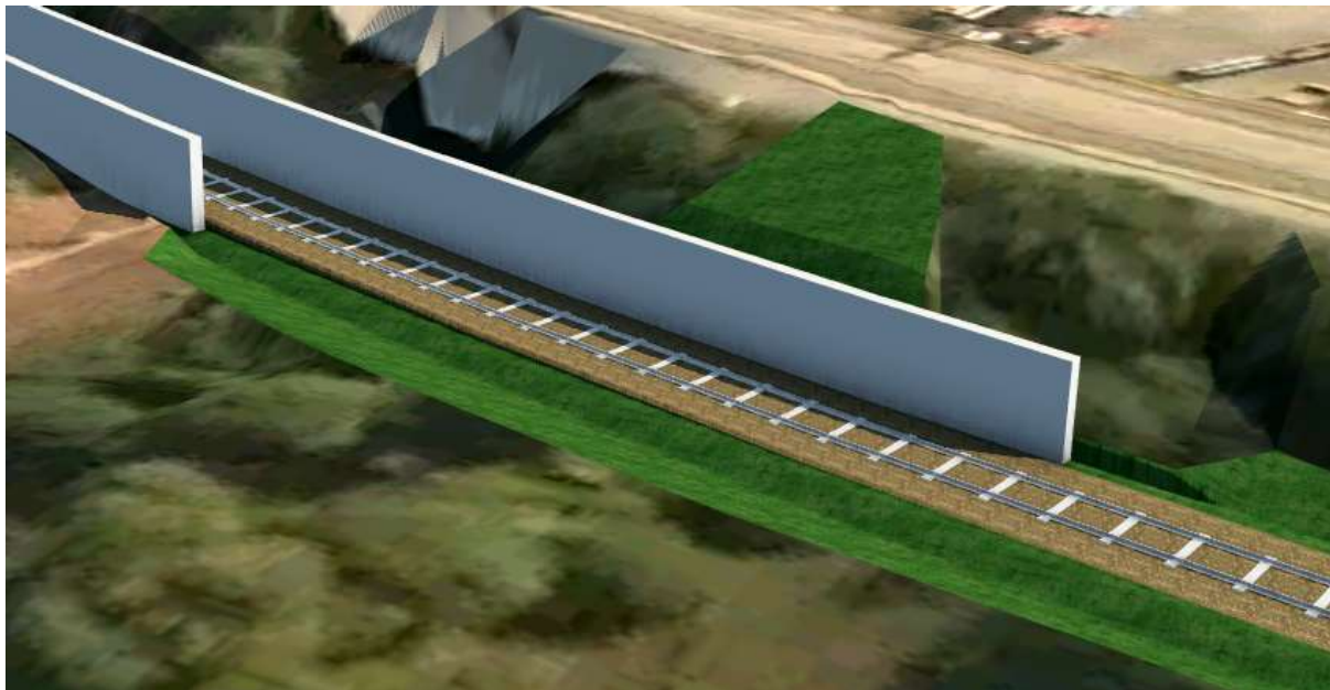
Figur 3-8 Støttemurskonstruksjon mot Elveveien i fortsettelsen av det sørlige traue. Terrengtet i modellen er ikke tilpasset mot konstruksjonen.
