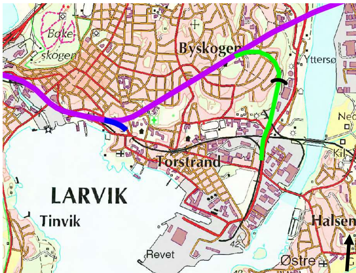
Figur 1-1 Grønn linje er havnesportilknytning via tunnel, blå linje er havnesportilknytning via Torstrand som kobles mot sort eksisterende spor. Lilla linje er trasé i Stålakerkorridoren via Stålaker øst koblet mot stasjonen i Indre havn-korridoren.
