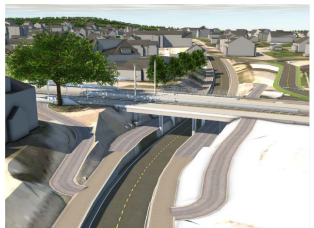
Figur 5-7 Viser prinsipløsning for Frederik Stangs gate hvor fortouene ligger høyere enn vegbanen under ny jernbane. Retning mot Sandefjord til venstre i bildet.
