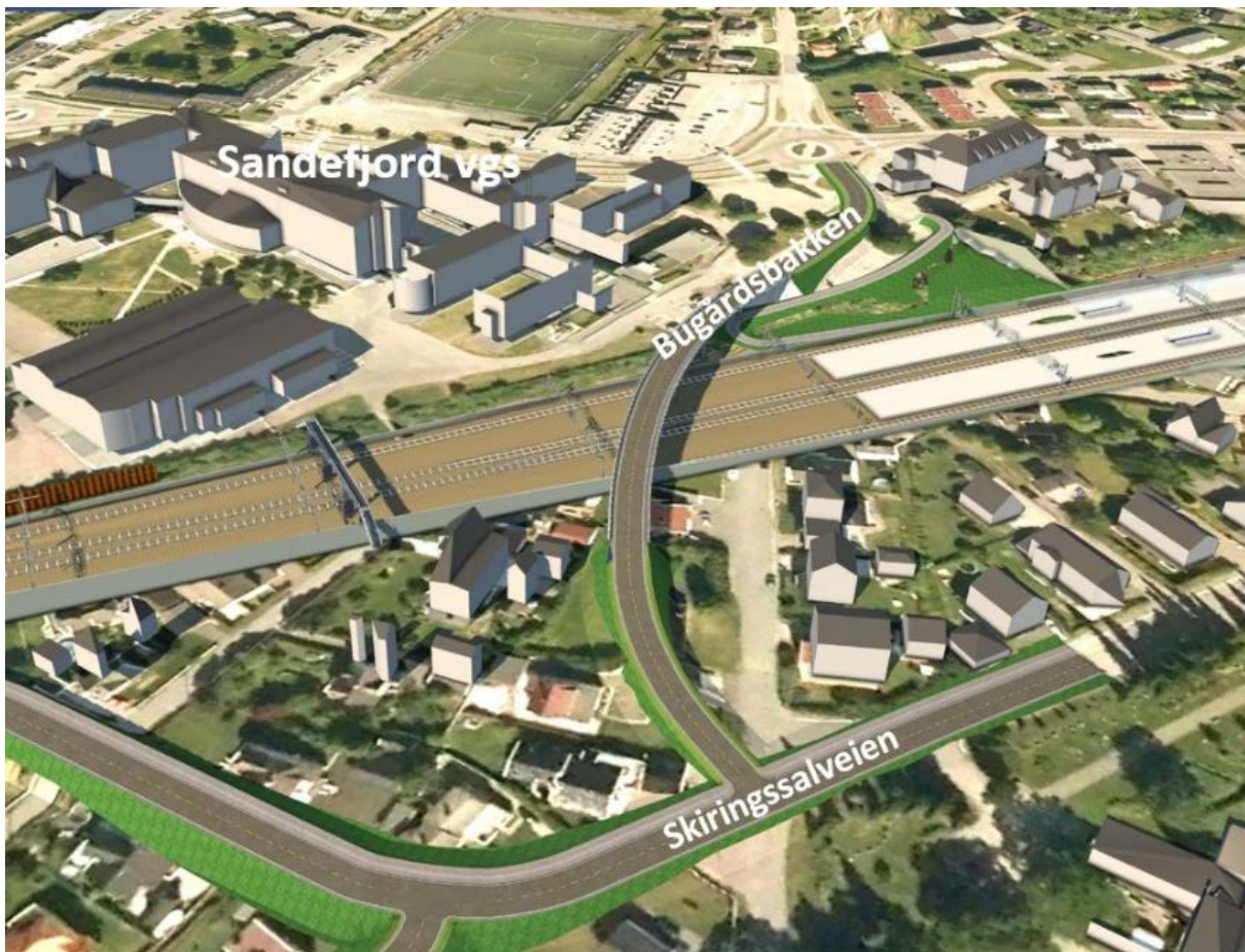
Figur 5-22 Foreslått kryssing av ny jernbane ved Sandefjord videregående skole. Universelt utformet gang-/sykkelkryssing i egen trasé ved stasjonen. Syd for stasjonen vises en kryssingsmulighet for gående via trapp. Retning mot Larvik til venstre i bildet.
