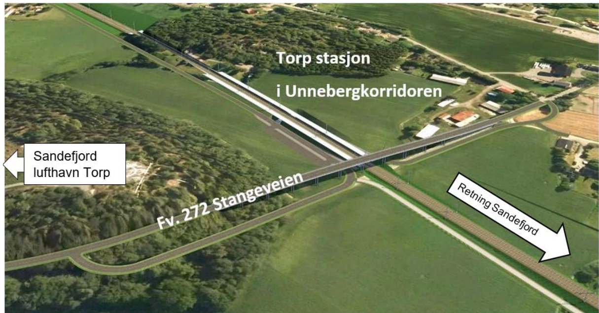
Figur 5-27 Fv. 272 legges på bru over spor med ramper på begge sider av spor for tilgang til stasjonsområdet og kobling til lokalveger/driftsveger. Retning mot Sandefjord til høyre i bildet.
