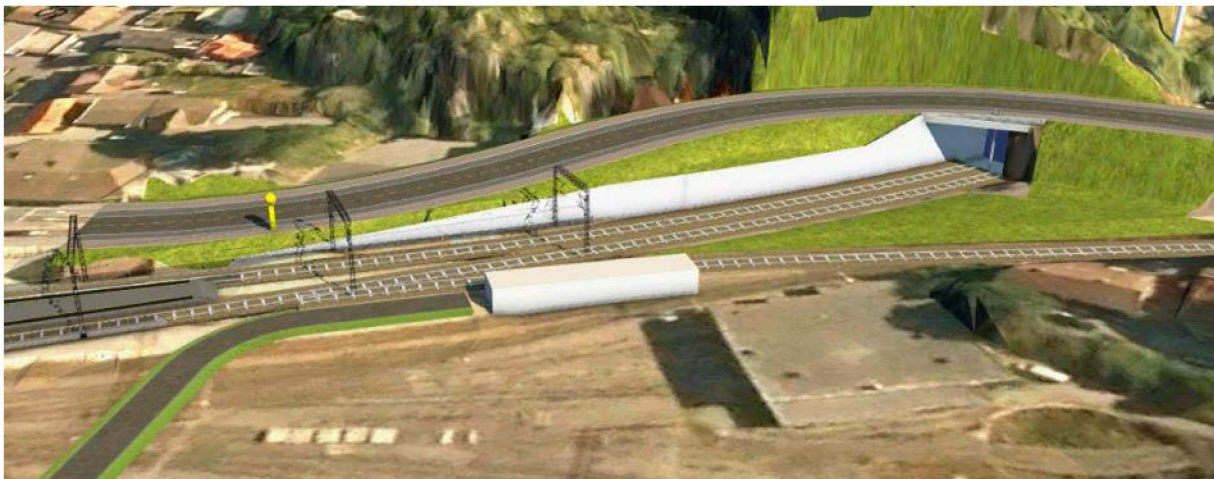
Figur 5-53 Tunnelportal ved Larvik stasjon med omlagt Storgata over portal. Retning mot Larvik stasjon til venstre i bildet.
