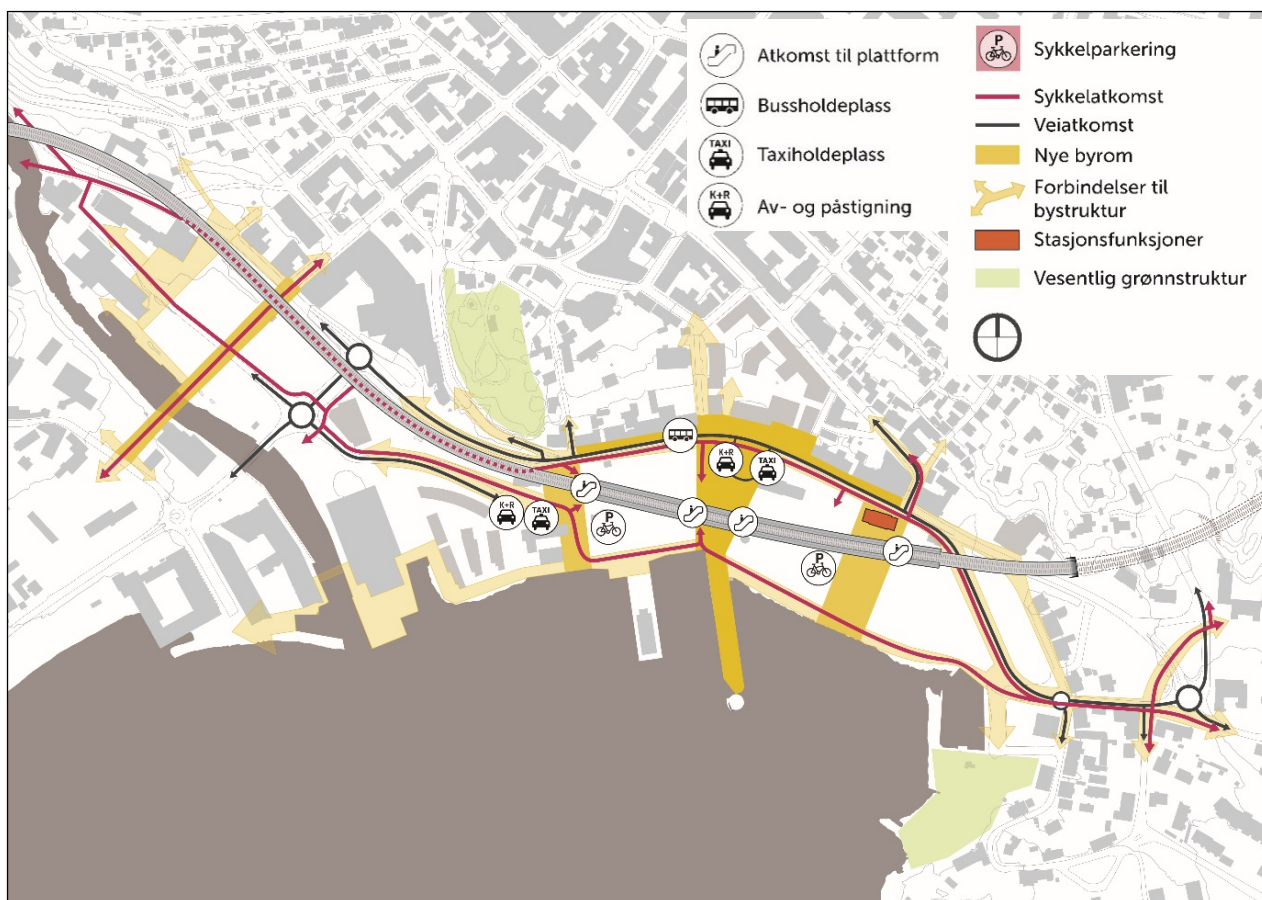
Figur 4-1 Diagram for utvikling av knutepunktet Larvik Indre havn høy. Stiplet rød linje viser gang- og sykkelveg under brukonstruksjonen for nytt jernbanespor.
