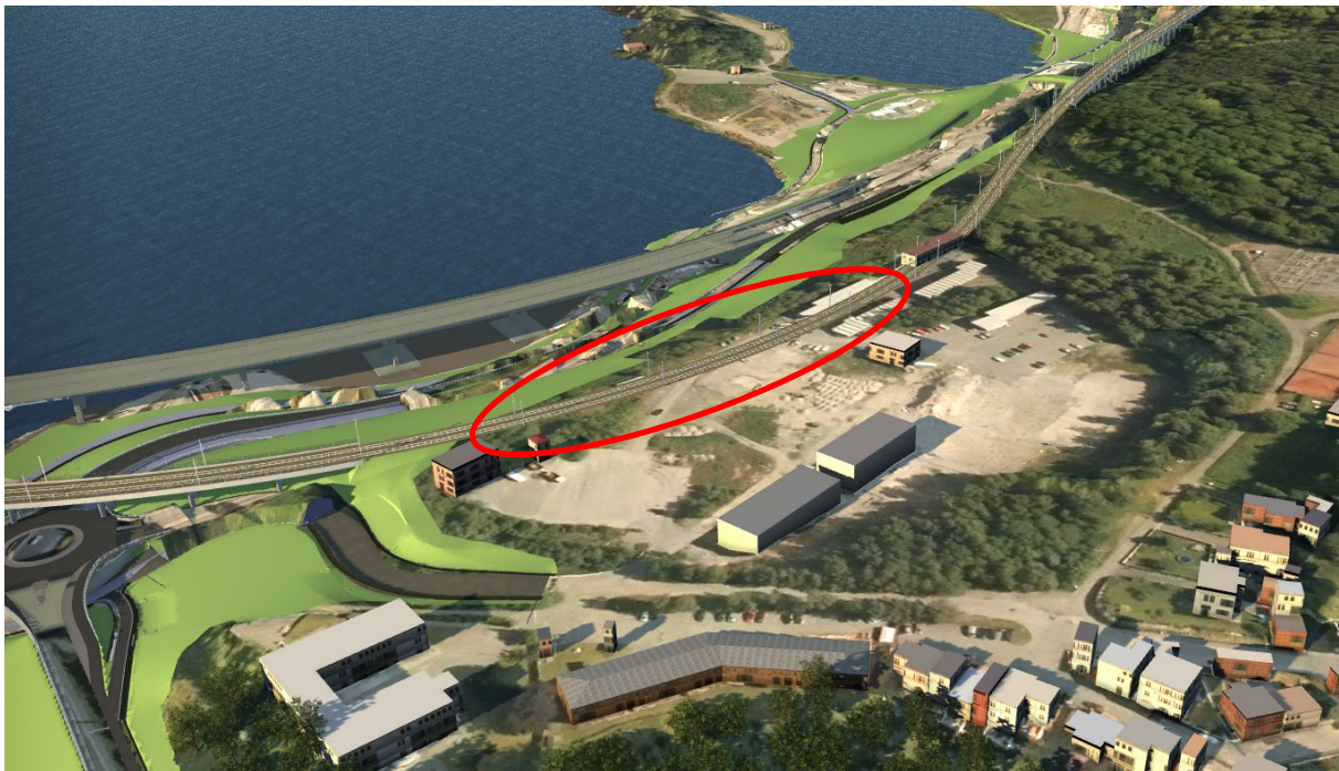
Figur 3-7 Bilde med foreslått område for eventuell stasjon på Bergeløkka i Bergeløkkalinja (angitt med rød ellipse). Stasjonen ligger i en krapp kurve inne på Bergeløkka, noe som ikke tilfredsstiller Teknisk Regelverk og Jernbaneinfrastrukturforskriften.
