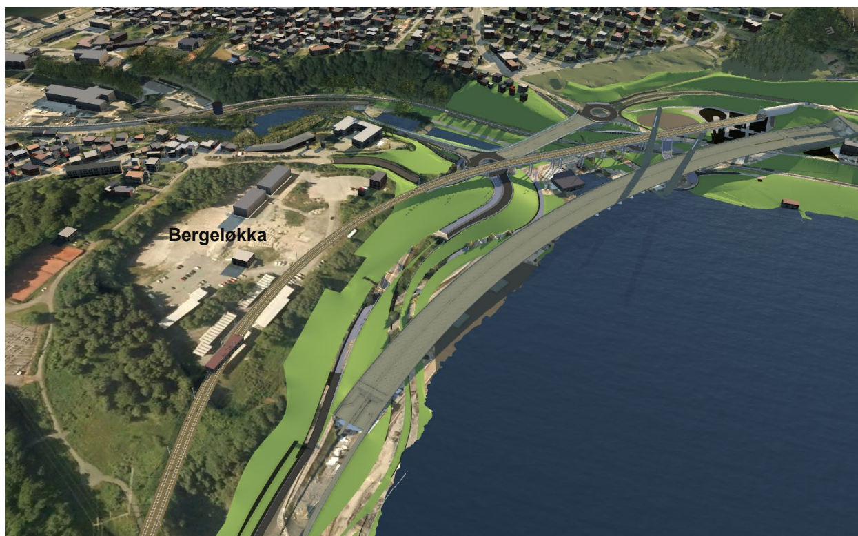
Figur 3-6 Bergeløkkalinja ligger i kurve over Bergeløkka-platået. Tunnelinnslag med forbindelse til Kleivertunnelen lengst til høyre i bildet. Stasjonsplattformer er ikke vist fordi sporet ligger i for krapp kurve til å tilfredsstille Teknisk Regelverk og Jernbaneinfrastrukturforskriften.
