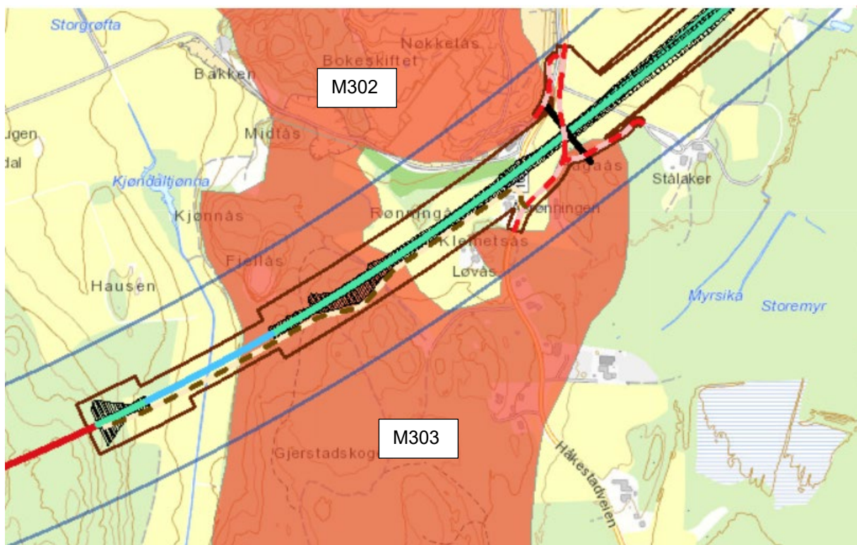
Figur 6-33. Larvikittressurser ved Stålakerbruddet (M302) og nord i Gjerstadskogen. Spor og omlegging av veger vil legge beslag på deler av ressursen i Gjerstadskogen (M303).
