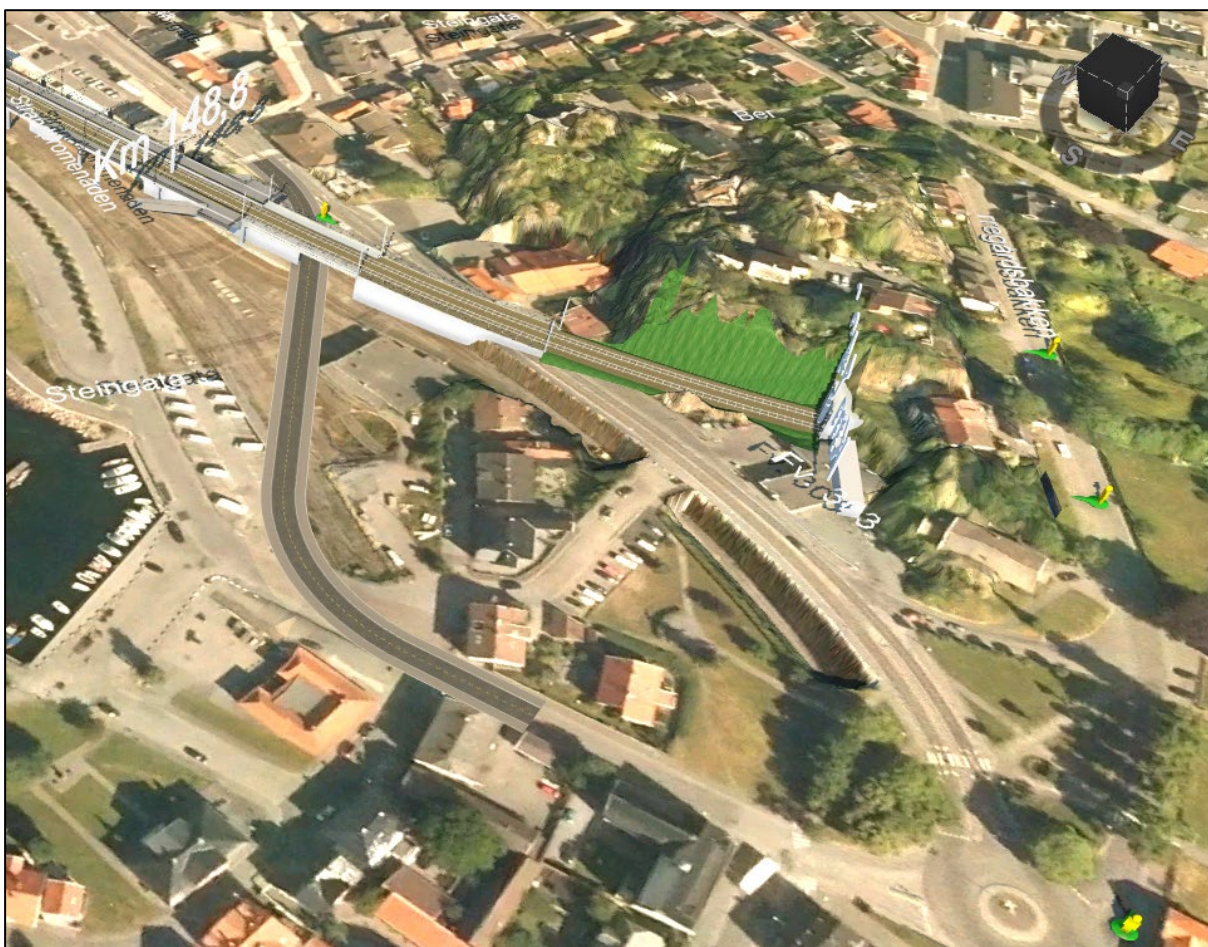
Figur 5-1 Omlegging av Storgata via Strandpromenaden og under ny jernbane.
