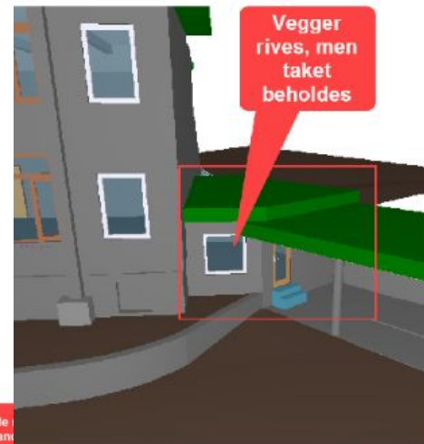
Figur 40. Utklipp av IFC-scanning modell datert 2022-11-21.
