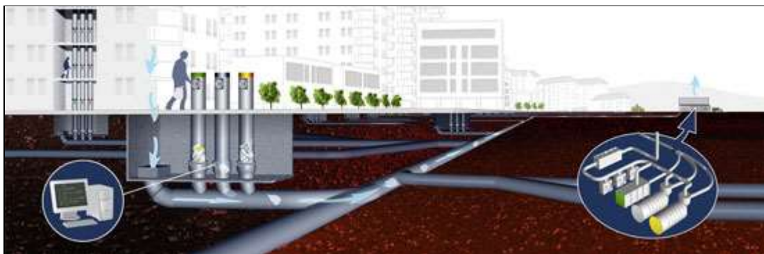
Figur 5-10 Stasjonært avfallssug. (Kilde: www.envac.no )
