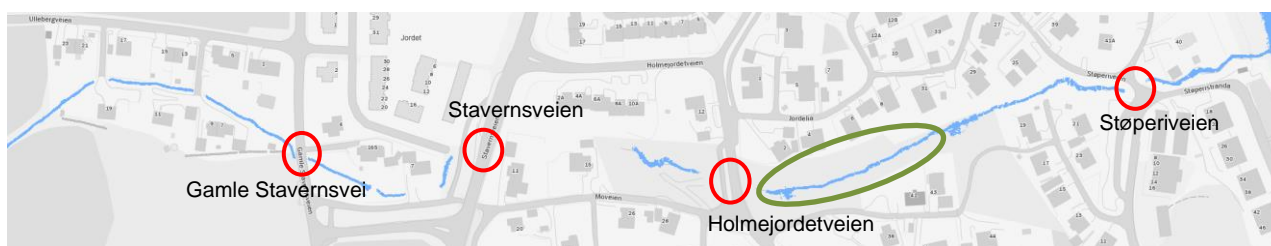
Figur 1 Påviste problemområder langs Holmejordetbekken. Grønn sirkel marker område med stabilitetsproblematikk.
