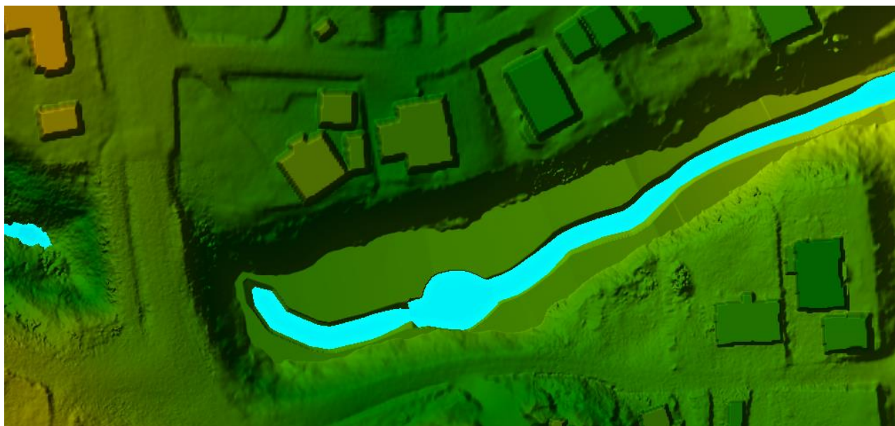
Figur 12 Oppfylling og nytt terreng med foreslått utforming av nytt bekkeleie. Vanddekket areal ved Q200klima er vist.
