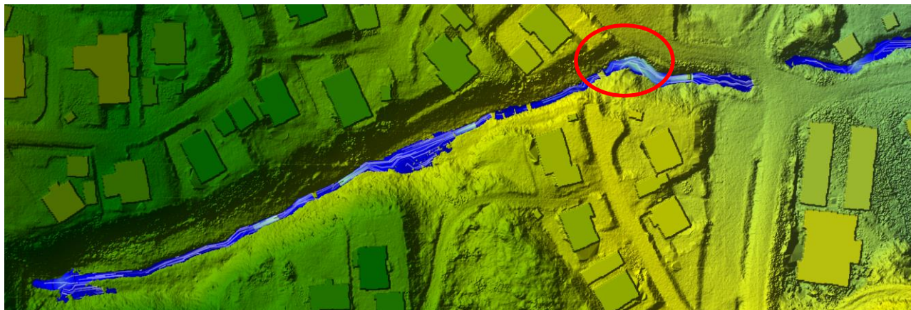
Figur 17 Vannhastigheter på strekningen mellom Holmejordetveien og Støperiveien.
