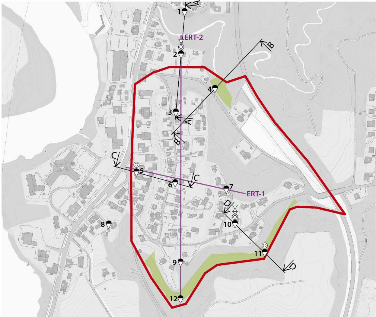
Figur 7.1 Eksempel på borplan for utredning av en kvikkleiresone (faresone) med fire antatt kritiske snitt (A, B, C og D) og to ERT-linjer (lilla), 12 borpunkt plassert i og rundt sonen for å gi grunnlag både til beregningssnittene og ERT, samt soneutstrekning. Antatte sikringstiltak etter første runde med beregninger er markert med grønt.
